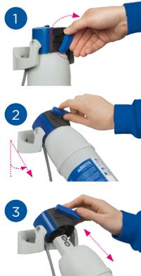
Um die Filterkartusche auszutauschen, Verriegelungsgriff öffnen. Spülventil betätigen und Filter drucklos machen.
